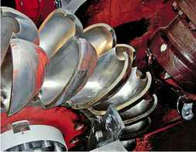
Pelton-Turbinenrad im Kraftwerk Obermatt
